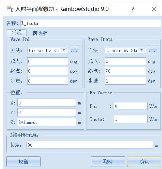
图 6-23 添加 E_theta 平面波激励
